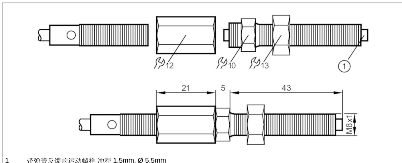
1 带弹簧反馈的运动螺栓 冲程 1.5mm, Ø 5.5mm
