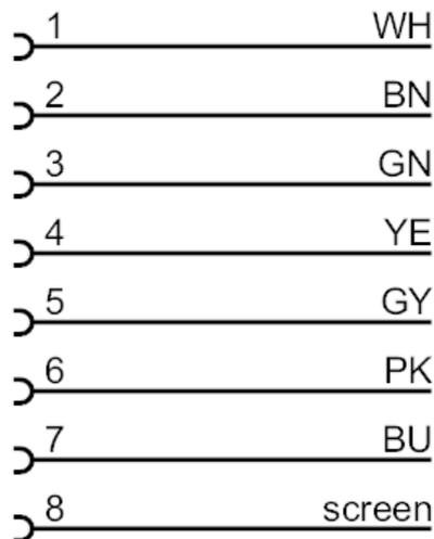
颜色符合DIN47100 标准 芯线颜色:
